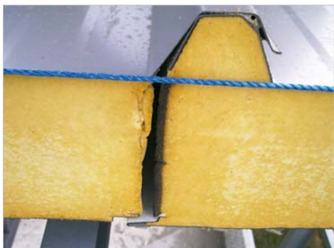
Пример некачественно выполненной панели производителем «второго» эшелона — замки не стыкуются
