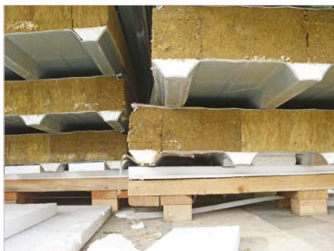
Нарушение правил хранения панелей приводит к их деформации, изменению геометрии и разрушению слоя утеплителя
